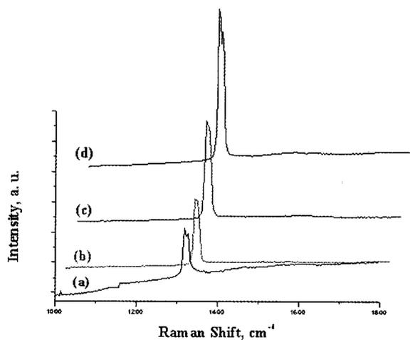
Fig. 6. Raman spectra of boron-doped diamond film on Si wafer. (3 hrs); (a) : 750°C, (b) : 820°C, (c) : 860°C, (d) : 980°C.
