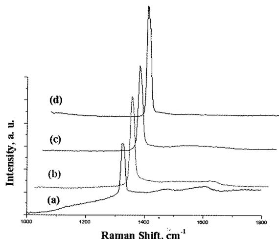
Fig. 8. Raman spectra of boron-doped diamond film (5 hrs); (a) : 750°C, (b) : 820°C, (c) : 860°C, (d) : 980°C.
