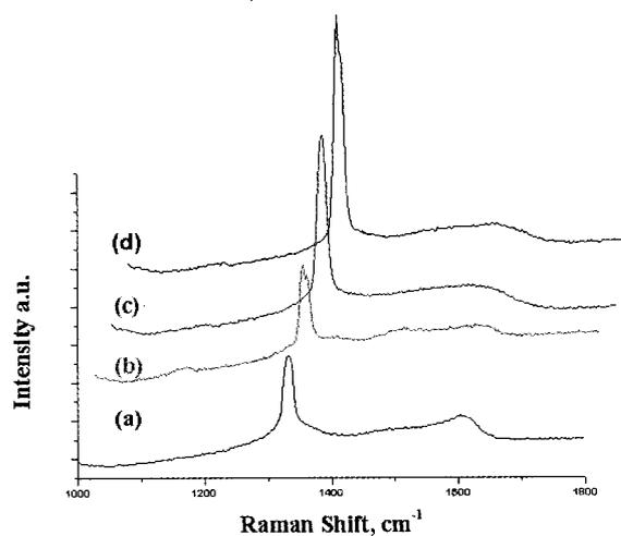
Fig. 4. Raman spectra of boron-doped diamond film(1hr); (a) : 750°C, (b) : 820°C, (c) : 860°C, (d) : 980°C.
